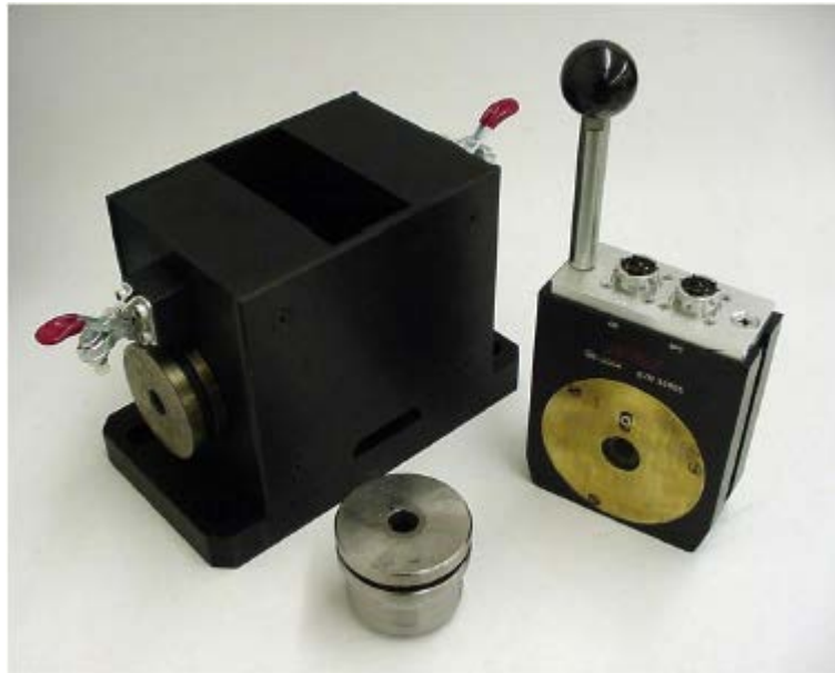
US-HS探头座及U40-GH导向器
